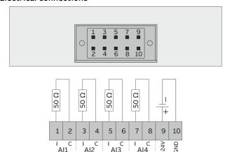
Figure 24: Analog input module
